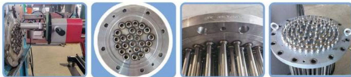
【管板自动焊接工艺】 Automatic welding process of tube-plate
